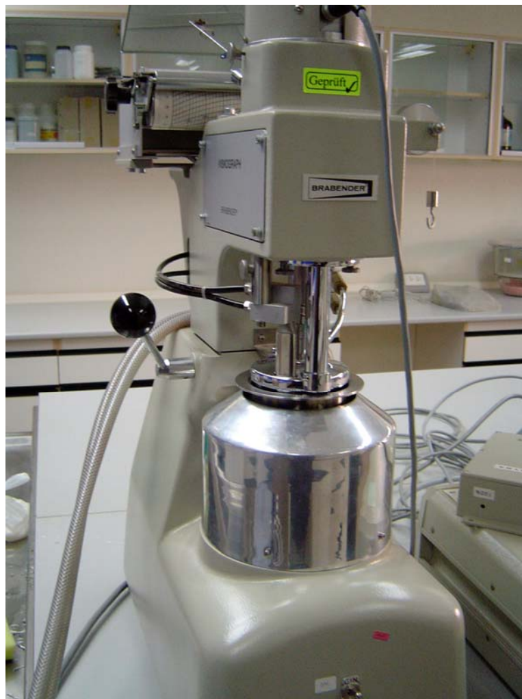
ภาพที่ 23 เครื่องวัดความหนืดแป้ง Brabender visco amylograph
