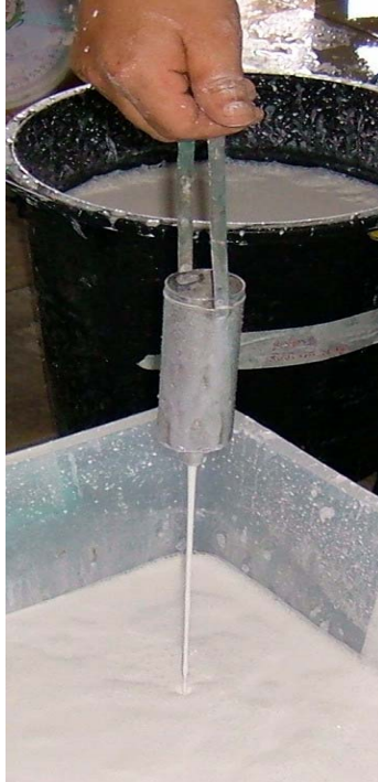
ภาพที่ 14 วัดความเข้มข้นของน้ำแป้ง
