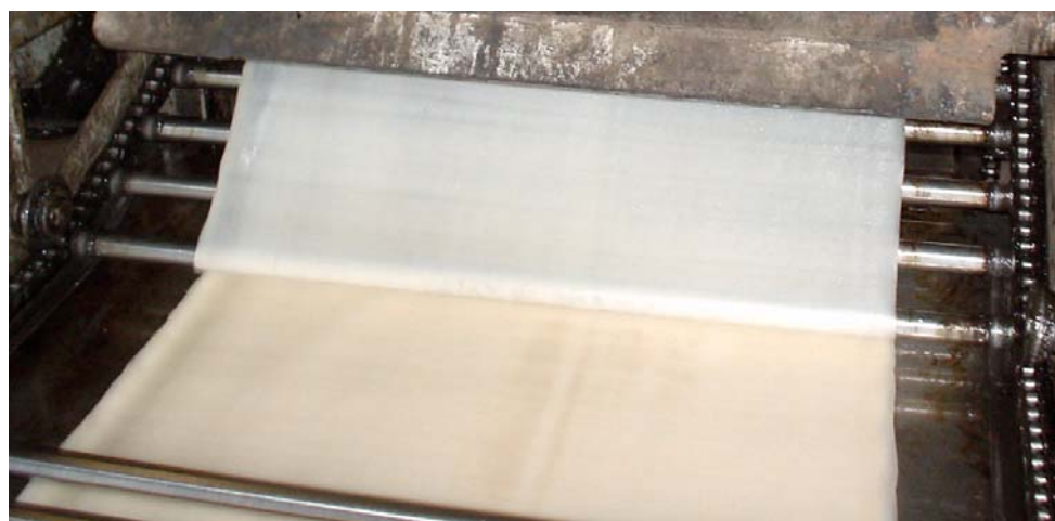
ภาพที่ 17 แผ่นแป้งที่นึ่งสุก และอบเพื่อลดความชื้น
