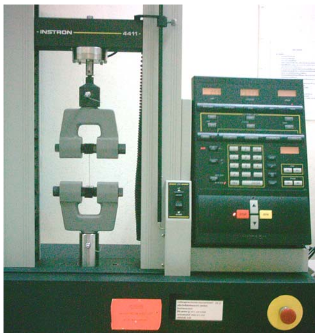
ภาพที่ 24 การวัดเนื้อสัมผัสของเส้นก๋วยเตี๋ยวสุกด้วยเครื่อง Instron Texture Analyzer
