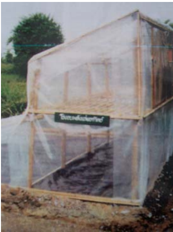
ภาพที่ 2 ตู้อบกล้วยพลังแสงอาทิตย์แบบเก่า
