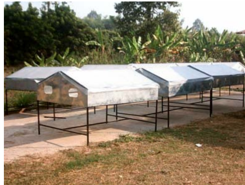
ภาพที่ 3 ตู้อบกล้วยพลังแสงอาทิตย์แบบใหม่
